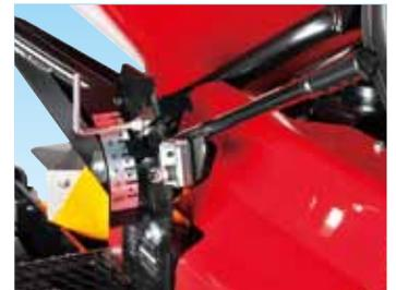
散布量調整レバーの無段階開閉化とストッパーにより、散布量の微調整が可能になりました。
