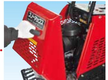
ワンタッチで開く前部カバー内にアワーメーター、エンジン、エアクリナーを配置し、メンテナンス性を向上。
