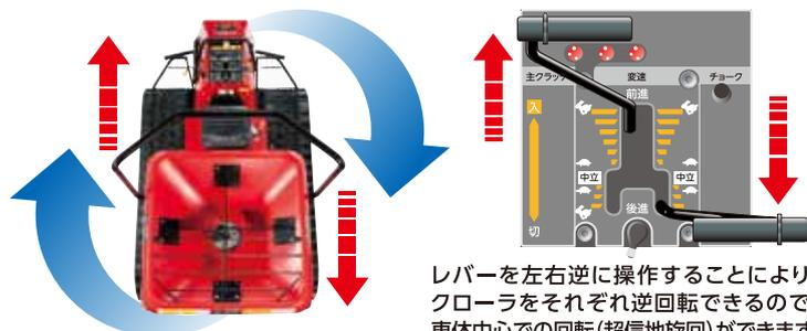
レバーを左右逆に操作することにより、クローラをそれぞれ逆回転できるので、車体中心での回転(超信地旋回)ができます。
