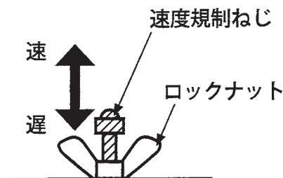
※速度規制ねじは、好みの作業速度（前進速度）に規制するためのねじです。後進速度は規制することができません。
